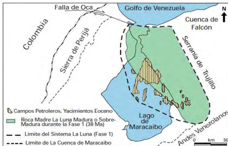
Figura 11. Sistema petrolero definido en la cuenca del Lago de Maracaibo, roca madre Formación La Luna, en la Fase 1 (38 Ma) (Modificado de Talukdar y Marcano, 1994)
